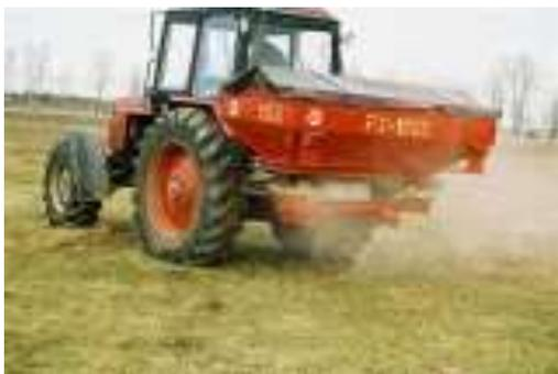
**Рисунок 3. Рассеиватель минеральных удобрений РУ-1600**
