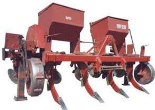
**Рисунок 12. Универсальная комбинированная почвообрабатывающая машина-гребнеобразователь**
