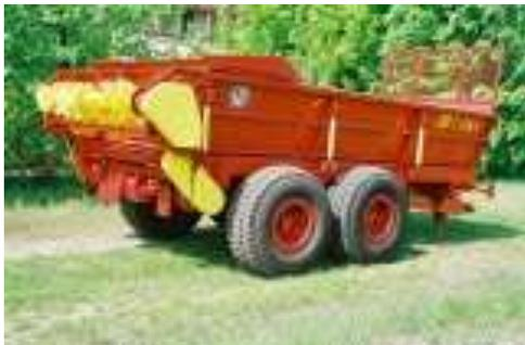
**Рисунок 8. Машина для внесения твердых органических удобрений ПРТ –7А**
