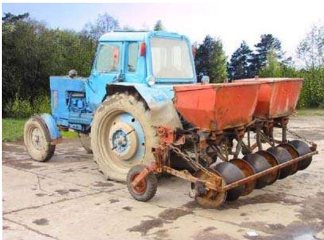
**Рисунок 11. Агрегат для локального внесения удобрений (разработчик СЗНИИМЭСХ)**
