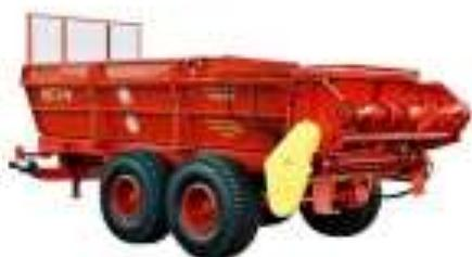
**Рисунок 9. Машина для внесения твердых органических удобрений МТТ-9**
