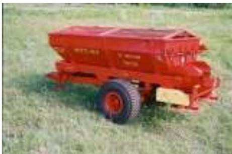
**Рисунок 2. Машина для внесения твердых минеральных удобрений МТТ-4У**
