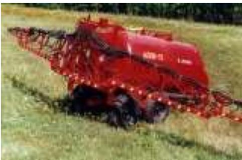
**Рисунок 7. Машина для внесения жидких минеральных удобрений АПЖ–12**
